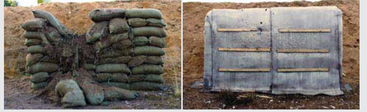
800 Atıştan Sonra Normal Kum Torbası Duvar
