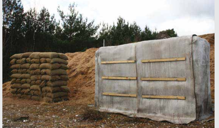
800 Atıştan Sonra Normal Kum Torbası Duvar
